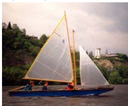
Pramice P520, oplachtění Scout 7 m 2
